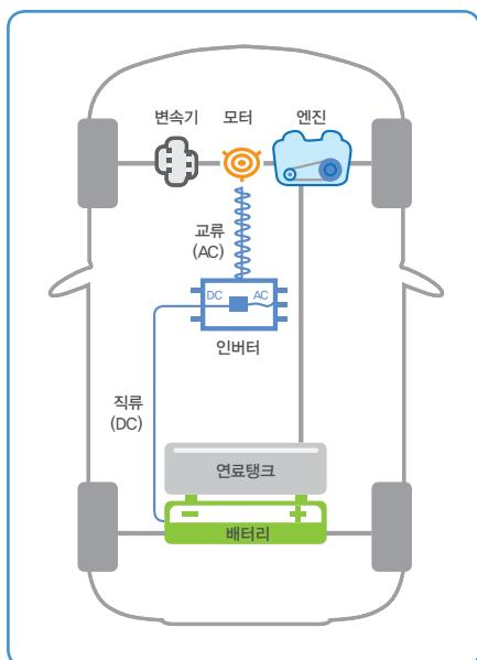
\* 인버터(Inverter) : 전기모터에서 생산된 교류를 직류로 변환시켜 배터리에 저장하고, 전기모터를 구동할 때는 배터리에 저장된 직류를 역(易)으로 교류로 변환시켜 전기모터에 공급하는 장치
